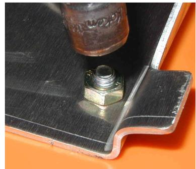
Die 4 Schrauben (Pos. 16) von der Innenseite des Rumpfes durch die Löcher stecken und mit den Muttern (Pos. 17) festschrauben.
