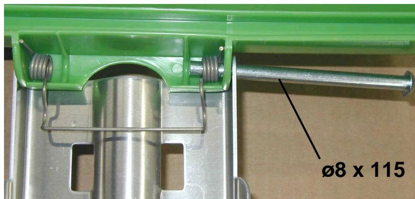
Nun den Niet (Pos. 3) durch diese Bohrungen und die Schenkelfeder führen.
