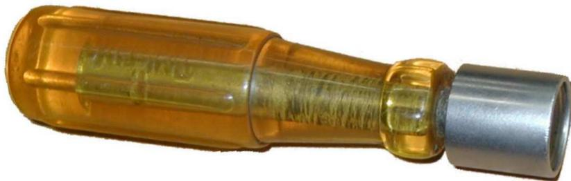
Montagewerkzeug für Starlockscheiben mit Kappe (Variant: 6, 8, und 10mm)
