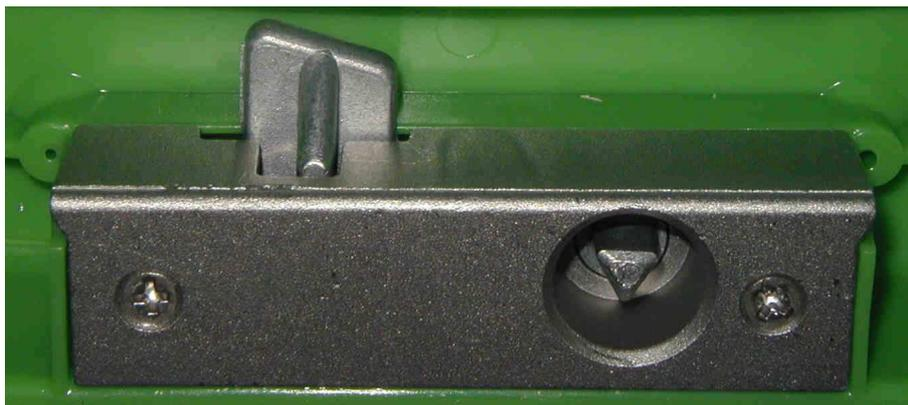
Die Schlossplatte (Pos. 9) mit den beiden Schrauben (Pos. 11) festschrauben und dann auf Funktion überprüfen. Mit dem Dreikantschlüssel (Pos. 20) den Dreikant nach links drehen, so das der Schlossriegel in der Schlossplatte verschwindet. Jetzt den Schlüssel abziehen und der Schlossriegel muss danach wieder in seine Ausgangslage zurückspringen.
