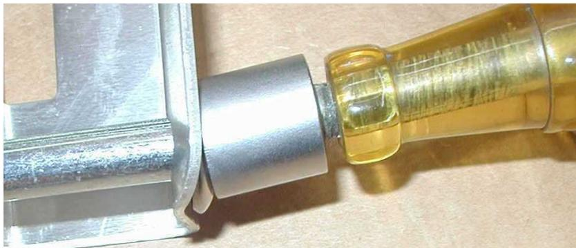
Den Niet (Pos. 6) durch die Bohrung im unteren Bereich des Befestigungsbleches stecken und dann mit dem Montagewerkzeug bei gleichzeitigem Gegenhalten des Nietes, die Starlockscheibe 10mm mit Kappe (Pos. 5) aufdrücken.
