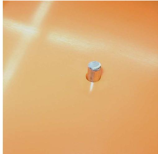
Den Bügel (Pos. 18) von der Innenseite des Rumpfes aus, durch die Löcher stecken (siehe Foto).
